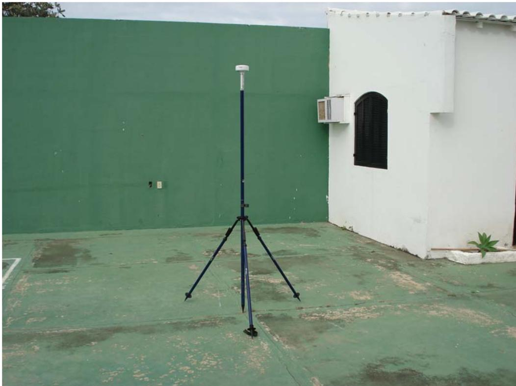
Figura 53: Estação base Pousada Mediterrâneo, referência para levantamentos GPS.
